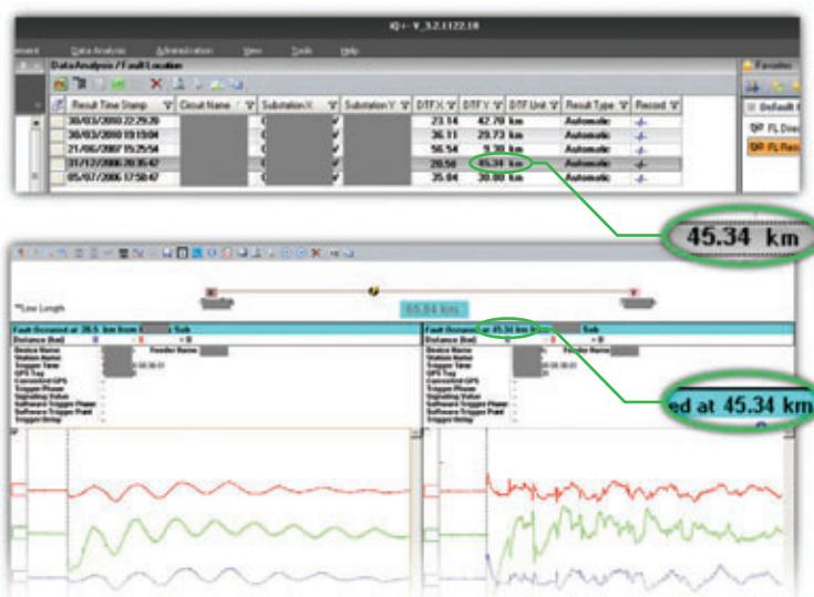
◀ Программный комплекс iQ+ и расчет расстояния до повреждения по методу «бегущей волны» от ПС X
